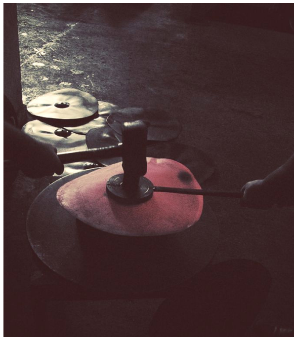
Abbildung 9: Das Pressen der Glocke bei Istanbul
