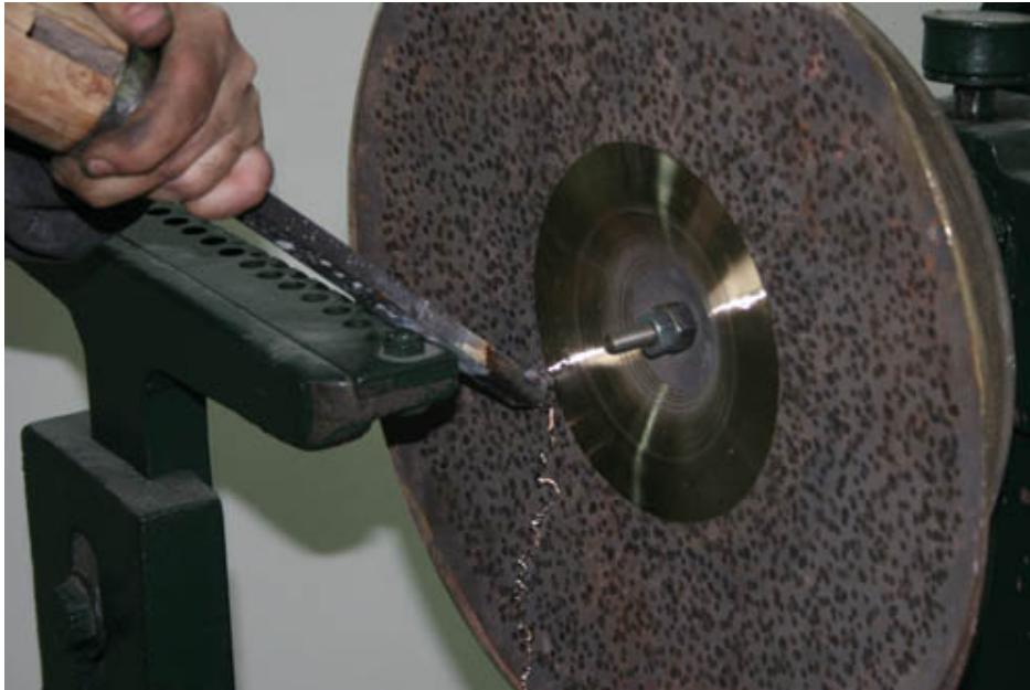
Abbildung 15: Abdrehen eines Beckens
