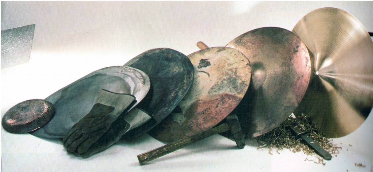
Abbildung 16: Die Stadien eines Becken des türkischen Herstellungsverfahrens (hier: Avedis Zildjian)
