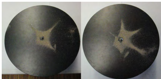
Abbildung 34: Chladnische Klangfiguren der Moden 20 und 30 auf einer Metallplatte durch einen Cellobogen erzeugt
