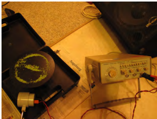
Abbildung 32: Versuchsaufbau mit Frequenzgenerator
