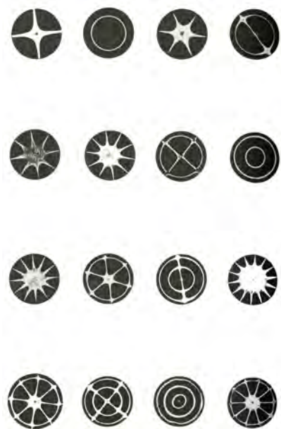
Abbildung 35: Chladnische Klangfiguren auf einer Platte (Bärnighausen, 1996, S. 12)
